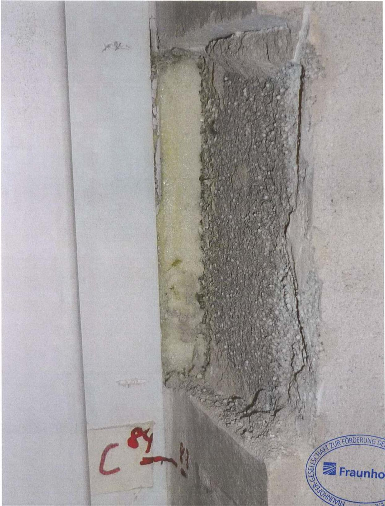
**Bild 8:** Detailansicht von der Probenentnahme für die gravimetrische Ermittlung des Wassergehalts in den an der Fuge beteiligten Materialien nach Prüfende, hier die Fuge C.
