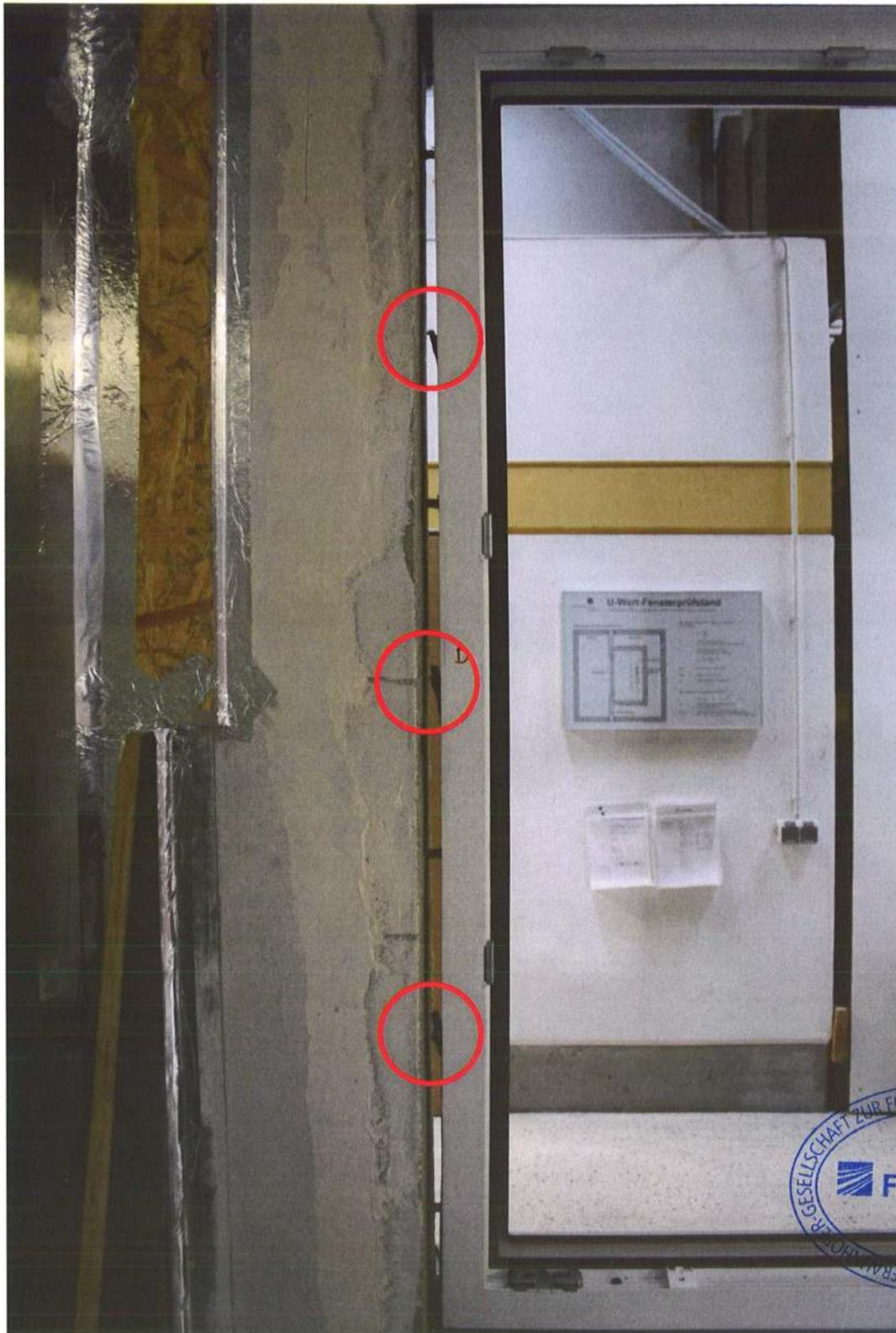
**Bild 2:** Detailansicht des Fugenbereichs vor dem Ausschäumen der 15 mm breiten Fuge. In den roten Kreisen sind die Feuchte-Sensoren und Temperaturfühler zu erkennen, die direkt mit eingeschäumt wurden. Diese Anordnung wurde für alle 4 Fugen A bis D so durchgeführt.
