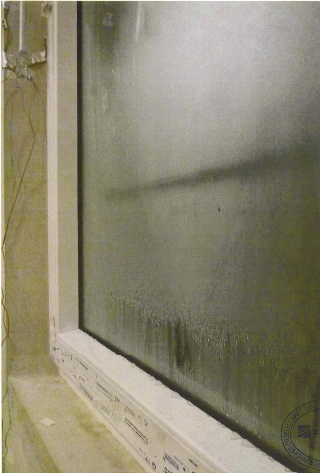
**Bild 9:** Detailansicht von Verglasung und Fensterrahmen mit deutlicher Tauwasserbildung auf der Innenseite (Warmseite) nach Prüfbeginn.
