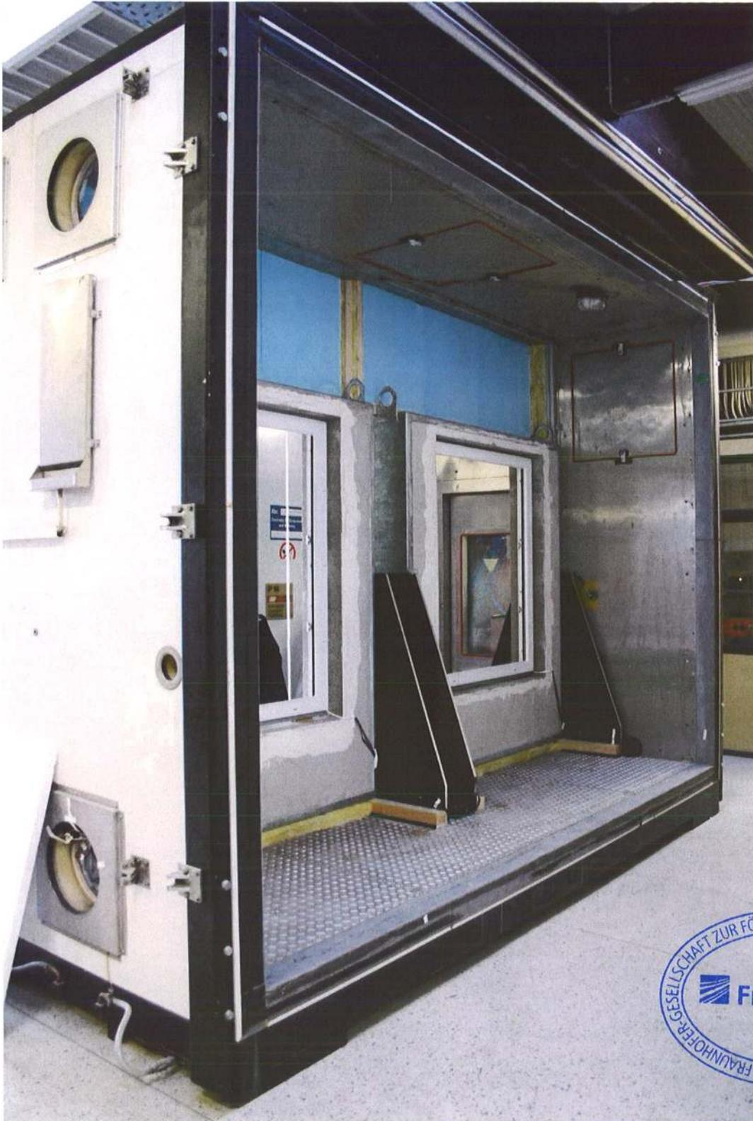
**Bild 1:** Mittleres Segment mit der Dow-Versuchsanordnung vor Einbau in den Klimasimulator am Fraunhofer IBP in Stuttgart.
